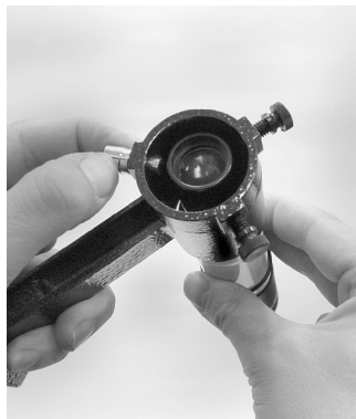
Figure 2b. Insertion du chercheur dans son support
