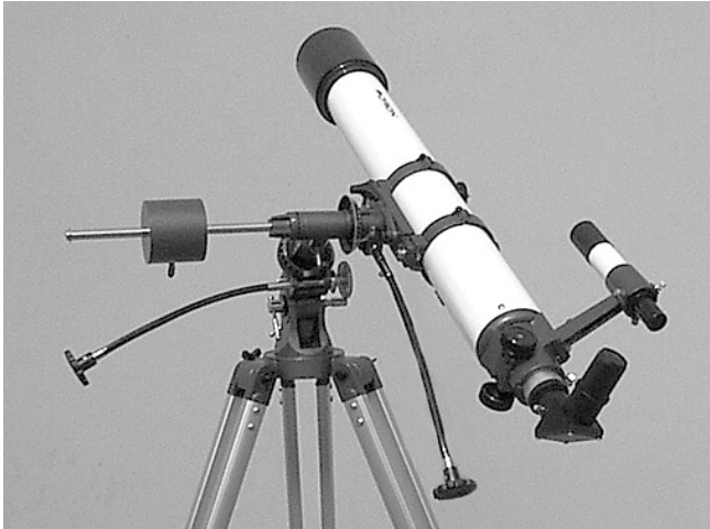
Figure 6a. Télescope orienté vers le sud. Notez que sur toutes ces illustrations, la monture et le trépied restent immobiles. Seuls les axes d'ascension droite et de déclinaison se déplacent.
