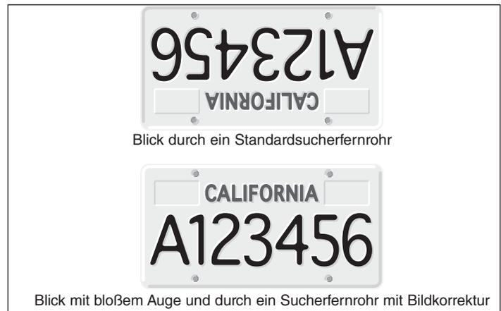
**Abbildung 2.** Das durch ein Standardsucherfernrohr dargestellte Bild ist um 180° gedreht. Bei Sucherfernrohren mit Bildkorrektur erscheint das Bild dagegen richtig herum und entspricht dem Blick mit bloßem Auge.
