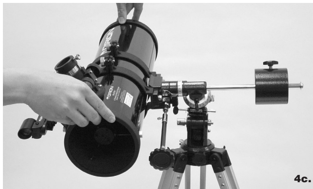
Abbildung 4. Um eine ordnungsgemäße Funktionsweise der parallaktischen Montierung zu gewährleisten, muss das Optikrohr des Teleskops sowohl auf der RA- als auch der Dek-Achse optimal ausbalanciert sein. (a) Lockern Sie die RA-Arretierschraube, und schieben Sie das Gegengewicht so an der Gegengewichtsstange entlang, dass ein perfektes Gleichgewicht mit dem Optikrohr herrscht. (b) Wenn Sie die Hände nun vom Teleskop nehmen, sollte sich das Optikrohr von selbst nicht mehr nach oben oder unten bewegen. (c) Lockern Sie die Dek-Arretierschraube und die Stellschrauben der Rohrschellen um einige Umdrehungen, und schieben Sie das Teleskop in den Rohrschellen je nach Bedarf vor oder zurück. (d) Wenn das Optikrohr auf der Dek-Achse optimal ausbalanciert ist, wird es seine Position auch dann beibehalten, wenn Sie die Hände vom Teleskop nehmen.
