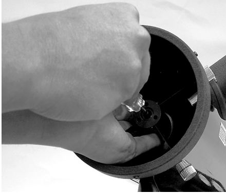
Abbildung 10. Zum Zentrieren des Sekundärspiegels unter dem Fokussierer halten Sie den Spiegelhalter mit den Fingern fest, während Sie die mittlere Schraube mit einem Kreuzschlitz-Schraubendreher festziehen. Berühren Sie keinesfalls die Spiegeloberfläche.
