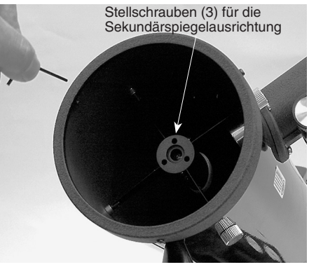
Abbildung 11. Um den Sekundärspiegel im Okularauszug des Fokussierers nach oben oder unten zu verschieben, drehen Sie die beiden Rändelmutter für die Strebeneinstellungen, die sich senkrecht zum Fokussierer befinden.
