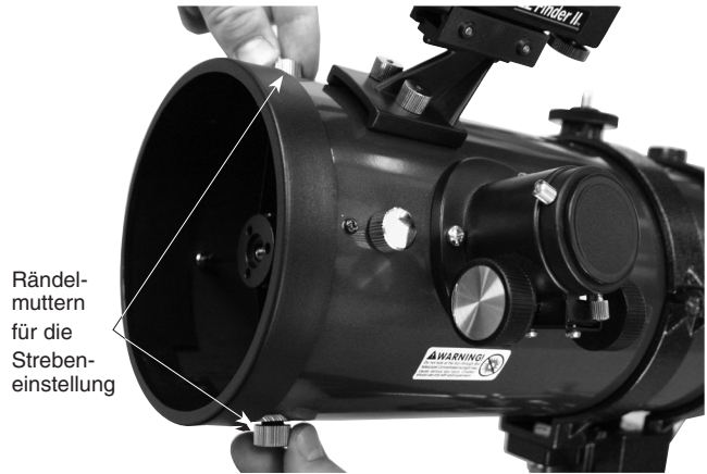
Abbildung 11. Um den Sekundärspiegel im Okularauszug des Fokussierers nach oben oder unten zu verschieben, drehen Sie die beiden Rändelmutter für die Strebeneinstellungen, die sich senkrecht zum Fokussierer befinden.
