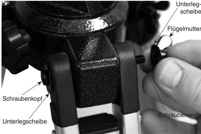
Abbildung 2. Befestigen Sie die Stativbeine mit den Schrauben an der Montierung, die bereits werkseitig oben in die Stativbeine eingesetzt sind. Legen Sie jeweils eine Unterlegscheibe zwischen den Schraubenkopf und das Stativbein und eine weitere Unterlegscheibe zwischen die Flügelmutter und das Stativbein.
