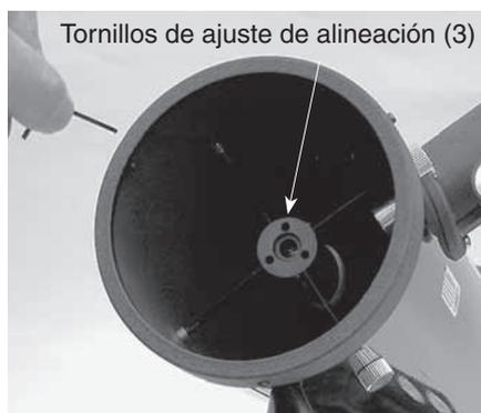
Tornillos de ajuste de alineación (3)
