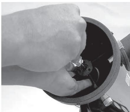
**Figura 10.** Para centrar el espejo secundario bajo el enfocador, sostenga el soporte del espejo secundario en su lugar con los dedos mientras ajusta el tornillo central con el destornillador Phillips. No toque la superficie del espejo.
