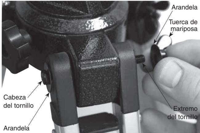
**Figura 2.** Acople las patas del trípode a la montura con los tornillos que vienen instalados en la parte superior de las patas del trípode. Debe colocarse una arandela entre la cabeza del tornillo y la pata del trípode y otra arandela entre la tuerca de mariposa y la pata del trípode.
