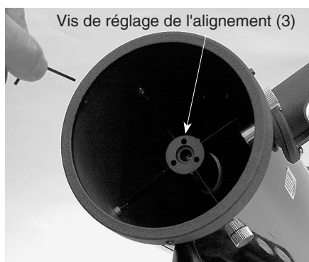
Figure 11. Pour centrer le miroir secondaire dans le sens vertical dans le tube télescopique du porte-oculaire, ajustez les deux vis papillon moletées des branches de l'araignée perpendiculaires au porte-oculaire.
