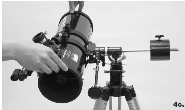
Figure 4. L'usage correct de la monture équatoriale exige que le tube du télescope soit équilibré sur les deux axes d'ascension droite et de déclinaison. (a) Avec le bouton de blocage de l'ascension droite déverrouillé, faites glisser le contrepoids le long de la barre de contrepoids jusqu'à ce qu'elle équilibre tout juste le tube. (b) Lorsque vous le lâchez des deux mains, le tube ne doit pas s'incliner vers le haut ou vers le bas. (c) Avec le bouton de blocage de la déclinaison déverrouillé, desserrez les fixations de verrouillage des bagues de tube de quelques tours et faites glisser le télescope vers l'avant ou vers l'arrière dans les bagues de tube. (d) Lorsque le tube est équilibré autour de l'axe de déclinaison, il ne bouge plus quand vous le lâchez.
