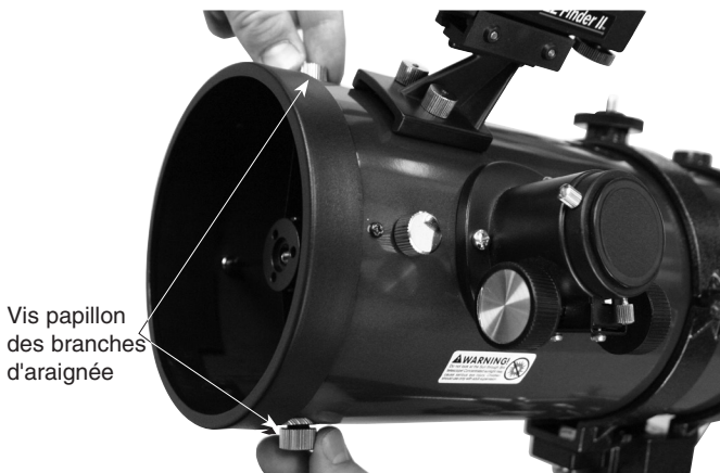
Figure 11. Pour centrer le miroir secondaire dans le sens vertical dans le tube télescopique du porte-oculaire, ajustez les deux vis papillon moletées des branches de l'araignée perpendiculaires au porte-oculaire.
