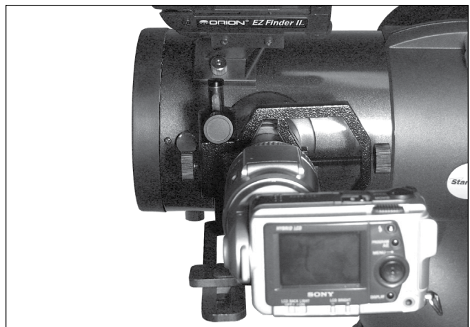
Abbildung 5. Eine auf der SteadyPix Deluxe-Kamerahalterung montierte und an einem Spiegelteleskop befestigte und einsatzbereite Kamera.
