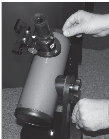
Abbildung 5: Ausrichten des FunScope 76-Teleskops
