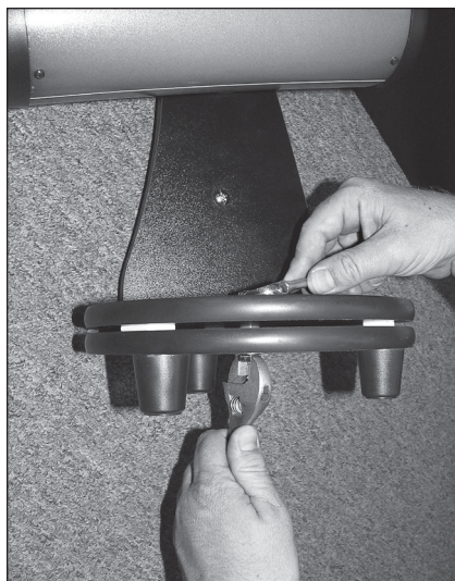
Abbildung 6: Einstellen der azimuthalen Vorspannung
