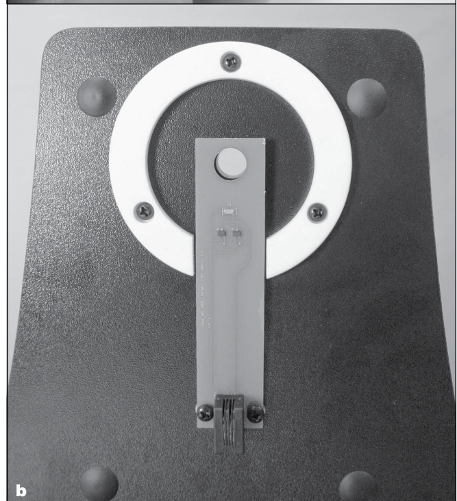
Abbildung 12. (a) Installieren der Platine für den Höhen-Encoder. Schieben Sie auf jede Schraube wie dargestellt eine Unterlegscheibe. (b) Die installierte Platine für den Höhen-Encoder.
