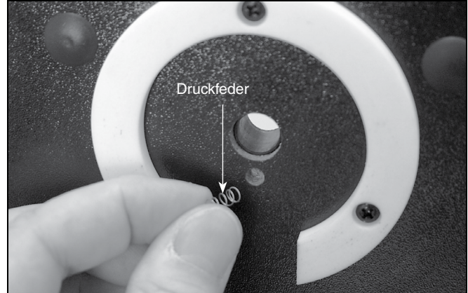
Abbildung 11. Setzen Sie die Druckfeder in die kleine Bohrung ein, die sich direkt unter der großen Bohrung für die Schraube der Höhenachse befindet.
