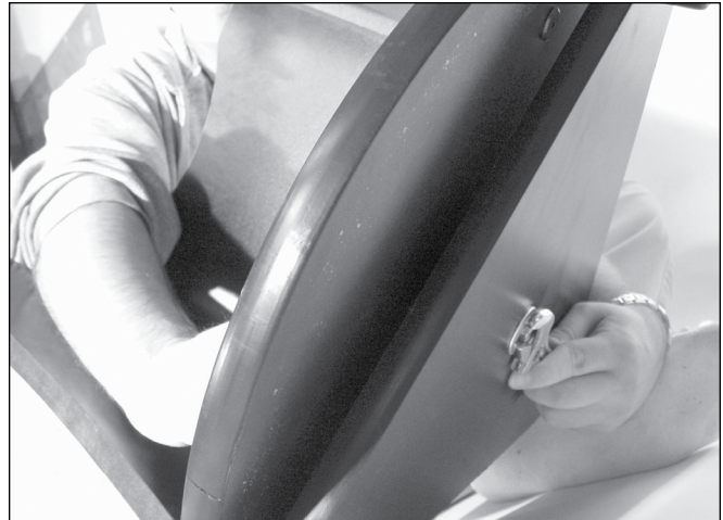
Abbildung 9. Achten Sie darauf, die Basisplatten zum Montieren nur leicht zu kippen (siehe Abbildung). Stellen Sie sie nicht auf die Seite. Halten Sie mit einem Schraubenschlüssel den Kopf der Schraube für die Azimut-Achse fest, während Sie die Sechskant-Kontermutter mit einem anderen Schraubenschlüssel festziehen.
