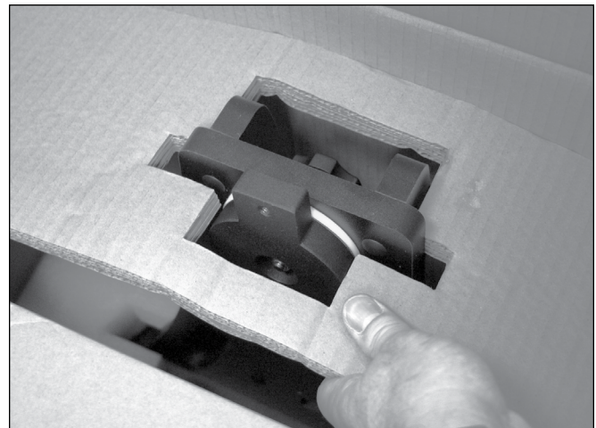
Abbildung 2. Um die Pappkartoneinlage an der Oberseite der azimutalen Montage zu entfernen, drehen Sie die Halterung der Teleskopmontierung so, dass die Längsachse vertikal ausgerichtet ist. Entfernen Sie dann die Einlage.
