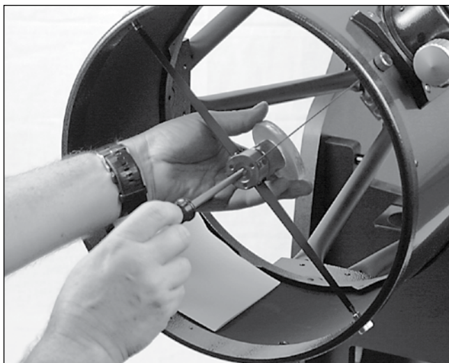
Figure 33. Pour centrer le miroir secondaire sous le système de mise au point, maintenez le support du miroir en place d'une main tout en ajustant le boulon central à l'aide d'un tournevis cruciforme.
