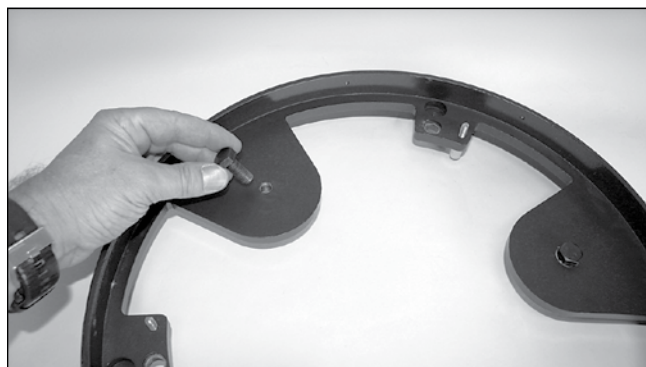
Figure 14. Vissez les trois boulons cruciformes de montage du contrepoids (uniquement XX14g) dans les orifices des plaques de support du contrepoids, comme illustré. Serrez à l'aide d'une clé réglable ou d'une clé à molette de 16mm.
