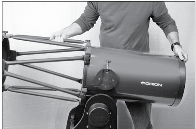
Figure 26. Pour monter l'ensemble monté du tube sur la base, tenez l'arrière du viseur d'une main et l'un des poteaux truss de l'autre. Le télescope étant orienté horizontalement, abaissez-le dans la base, en glissant la rainure en queue d'aronde dans le palier d'altitude gauche sur la section d'accouplement du tournillon métallique du panneau latéral gauche.
