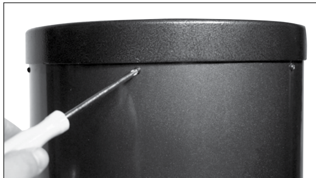
Figure 13. Pour retirer la bague d'extrémité, dévissez les vis cruciformes qui la fixent au tube.
