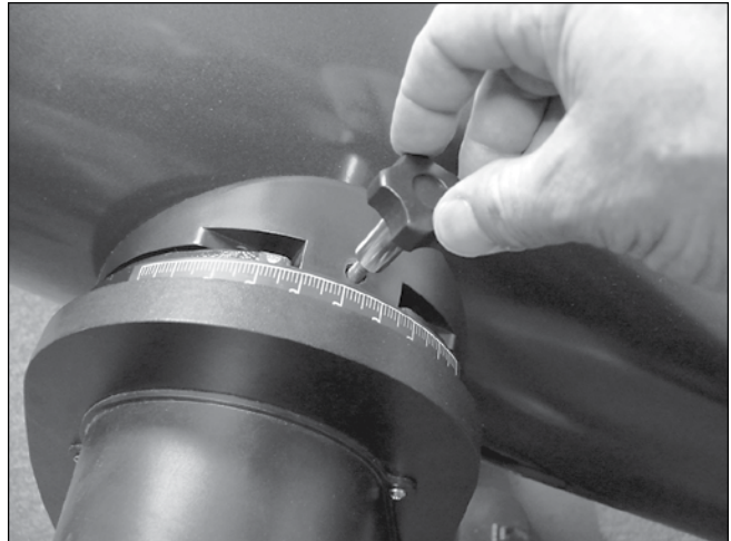
Figure 25. Fixez le tube sur la base à l'aide du bouton d'assemblage du tube.
