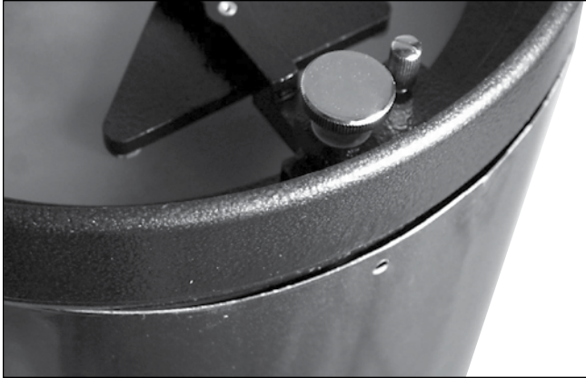
Figure 16. Localisez le renflement du tube qui empêche la bague d'extrémité de s'asseoir totalement. Appuyez sur cet renflement jusqu'à ce que le barillet du miroir repose correctement sur le tube. Faites attention de ne pas vous pincer les doigts !
