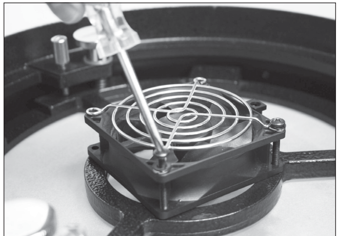
Figure 4b. Fixation du ventilateur à la cellule de miroir.
