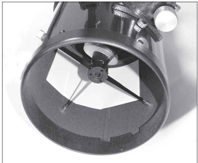
Figura 10. L'inserimento di un pezzo di carta bianca nel tubo ottico di fronte al foceggiatore fornisce uno sfondo luminoso quando si guarda nel foceggiatore.
