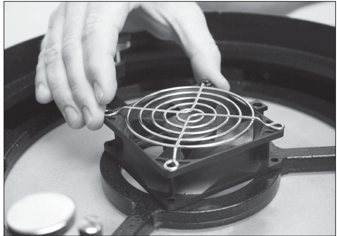
Figura 4a. Allineare i fori della ventola e del relativo coperchio con i fori dietro l'alloggiamento dello specchio primario.
