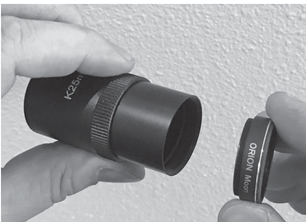
Figure 13. Les oculaires Kellner ont des barillets filetés pour s'adapter aux filtres optionnels Orion 1.25" (31,75 mm). Un filtre lunaire est utile pour réduire la lumière éblouissante de la Lune et révéler plus de détails de la surface lunaire.
