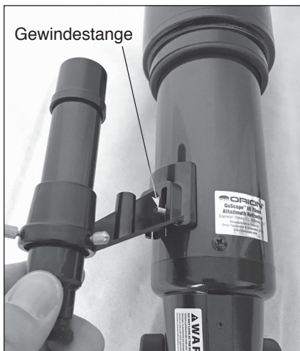
Abbildung 9. Um die Halterung des Sucherfernrohrs zu installieren, entfernen Sie die beiden Rändelmutter am Optikrohr, um die Gewindestangen freizulegen; anschließend legen Sie die Halterung auf die Stangen. Befestigen Sie sie mit den zwei Rändelmuttern.
