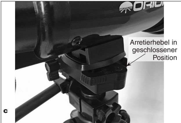
Abbildung 6. a) Befestigen Sie die Schnellwechselplatte an der Gabelmontierungsplatte des Teleskops. b) Schieben Sie die Schnellwechselplatte in den Sattel des Schwenkkopfs, indem Sie sie neigen und dann nach unten drücken. c) Schließen Sie dann den Arretierhebel, um das Teleskop auf dem Schwenkkopf zu fixieren.
