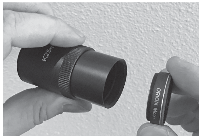
Abbildung 14. Die Steckhülsen der Kellner-Okulare sind mit Gewinde versehen, in die separat erhältliche 1,25" (32 mm) Orion-Filter passen. Ein Mondfilter ist nützlich, um Blendung zu reduzieren und so mehr Details auf der Mondoberfläche zu zeigen.
