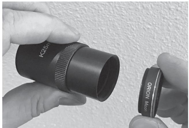
**Figure 14.** Les oculaires Kellner ont des barilets filetés pour s'adapter aux filtres optionnels Orion 1.25" (32 mm). Un filtre lunaire est utile pour réduire la lumière éblouissante de la Lune et révéler plus de détails de la surface lunaire.
