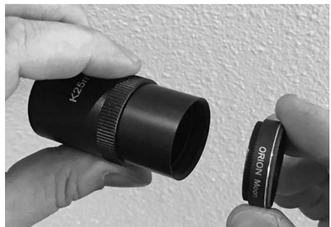
Figura 14. Los oculares Kellner tienen cilindros roscados que admiten filtros opcionales de 31,75 mm de Orion. Un filtro lunar es útil para reducir el resplandor y ver más detalles de la superficie lunar.
