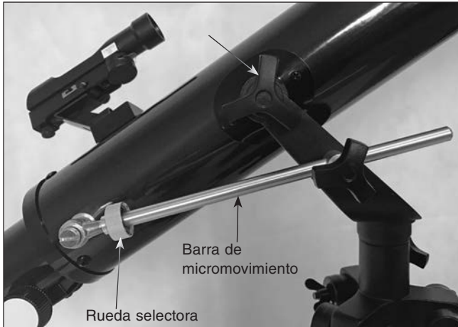
Figura 13. La rueda selectora y la barra de micromovimiento permiten un control de apuntado preciso de la altura.
