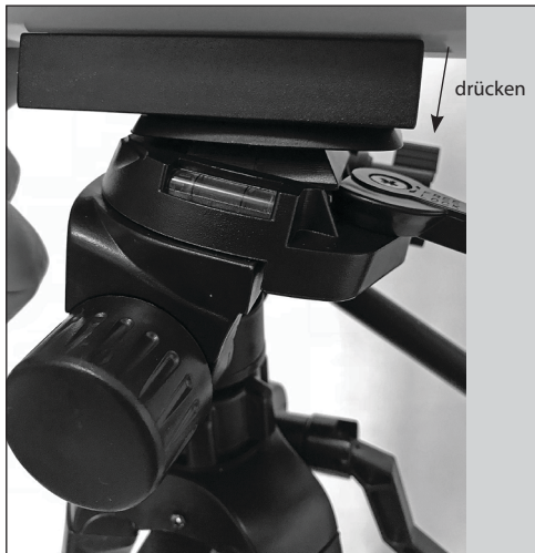
Abbildung 6. Drücken Sie die QR-Platte in den Sattel, um den Verriegelungshebel zu lösen, und drücken Sie ihn dann zu.
