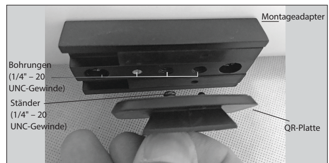
Abbildung 5. Befestigen Sie die Schnellwechselplatte (QR) am Montageadapter an der Unterseite des optischen Teleskoptubus.
