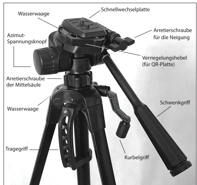
Abbildung 4. Der Schwenkkopf des Stativs GoScope 80.
