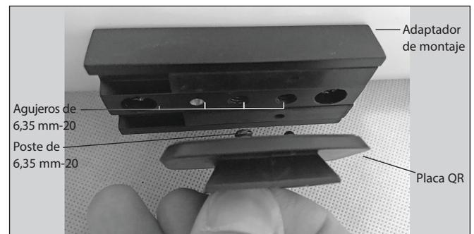
Figura 5. Coloque la placa de liberación rápida (QR) en el adaptador de montaje que hay en la parte inferior del tubo óptico del telescopio.
