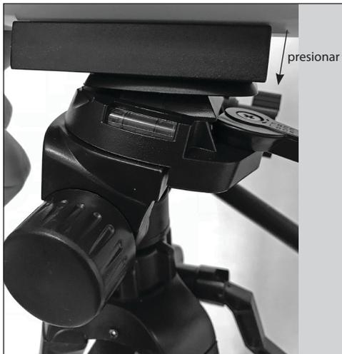
**Figura 6.** Presione la placa QR en el soporte para liberar la palanca de bloqueo abierta; luego empujela para cerrarla.
