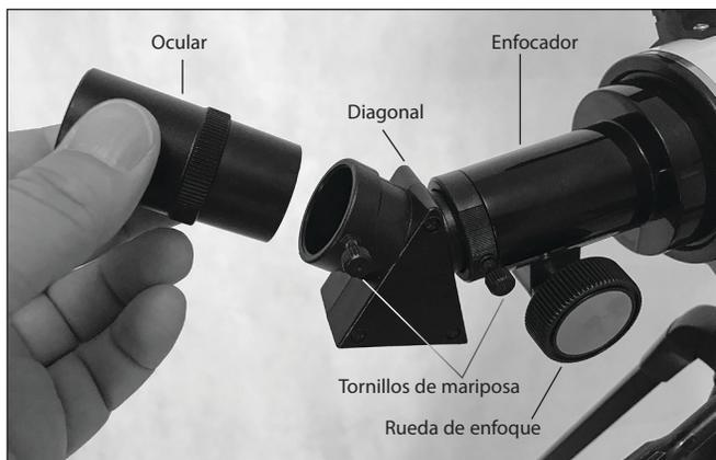
**Figura 8.** Monte la diagonal y un ocular en el enfocador como se muestra.
