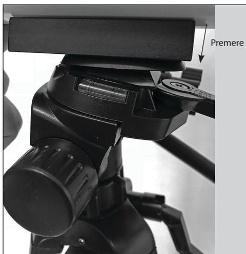
**Figura 6.** Premere la piastra QR nella slitta per aprire la levetta di blocco, quindi chiuderla.
