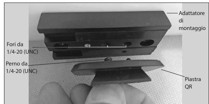
**Figura 5.** Fissare la piastra a sgancio rapido (QR) all'adattatore di montaggio sotto il tubo ottico del telescopio.
