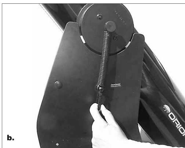
Figura 8. (a) Para adjuntar el resorte a la base, agarre el anillo de tirar con el dedo índice y tire del resorte hacia abajo. (b) Mientras tira, deslice el anillo final del resorte sobre la cabeza del perno y sobre la parte estrecha del separador de nylon. Después suelte el anillo de tirar.
