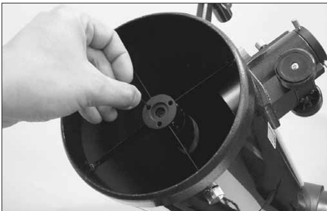
Figura 15. Ajuste la inclinación del espejo secundario aflojando o apretando con una llave hexagonal de 2mm los tres tornillos de alineación.
